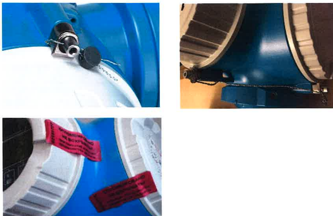
Рисунок 3 - Пломбирование корпуса измерительного преобразователя.
